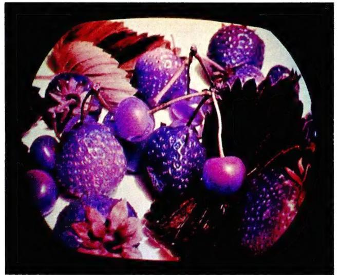
NTSC. Phasenfehler etwa -70^\circ
