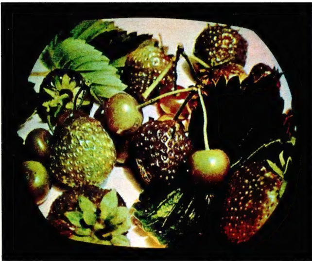
NTSC. Phasenfehler etwa +70^\circ
