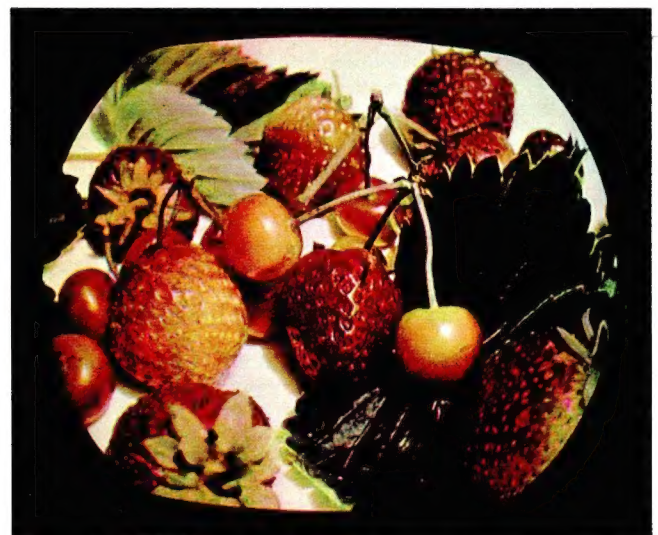
PAL. Phasenfehler \pm 70^\circ
